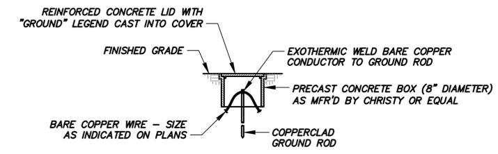
**GRW TYP** TYPICAL GROUND ROD AND WELL DETAIL
