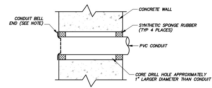
**CWP TYP** TYPICAL CONCRETE WALL PENETRATION DETAIL
