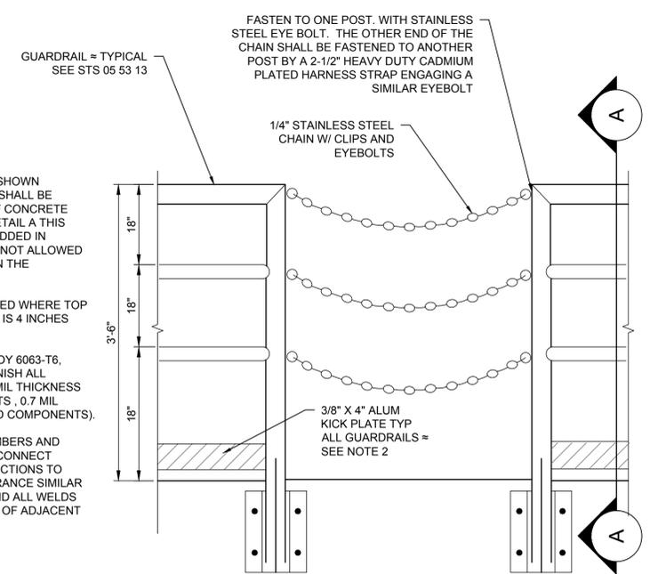
1 TYPICAL GUARDRAIL ELEVATION
